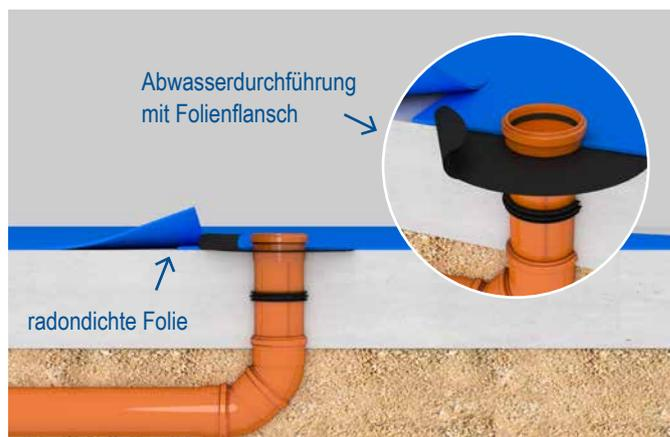
*Sichere Einbindung der radondichten Folie über Folienflansch.*
