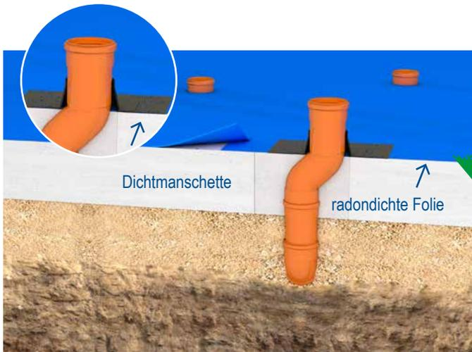
Mögliche nachträgliche Abdichtung einer Rechteckaussparung mit Radonfolie und Radon Dichtmanschette.
