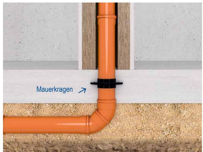
Sichere Abdichtung der Abwasserleitung mit einem Mauerkragen.
