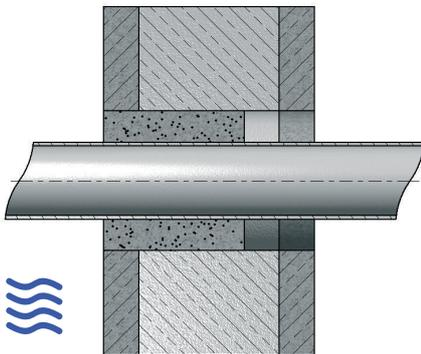
Für die Einbringung des fließfähigen Dichtsystems ist ein Mindestens-Ringspalt erforderlich, hierfür sind die Herstellerangaben zu den Durchbruchdurchmessern in Abhängigkeit der Leitungsdimension zu beachten.
