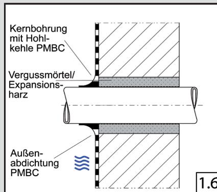
Wandeführung Wandeführung Mauerwerk-/ Betonwand mit Anschluss an Leitung (ist vorab mit dem Leitungsbetreiber abzustimmen)
