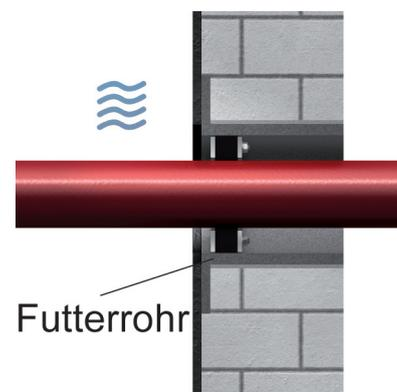
Nicht wasserdichte Bauwerke werden mit einer sogenannten Hautabdichtung nach DIN 18533 abgedichtet. Diese Hautabdichtung muss im Bereich der Leitungsdurchdringung mit eingebunden werden.
