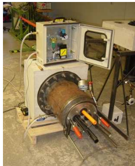
Prüfung der Dichtheit
