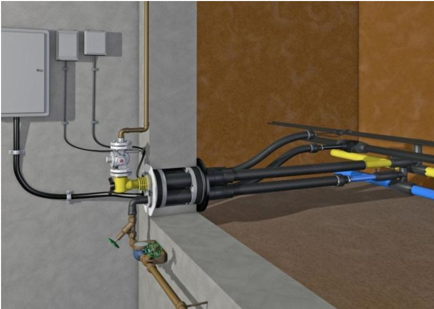
Bild 1: Mehrspartenhauseinführung mit Leerrohrtrasse
