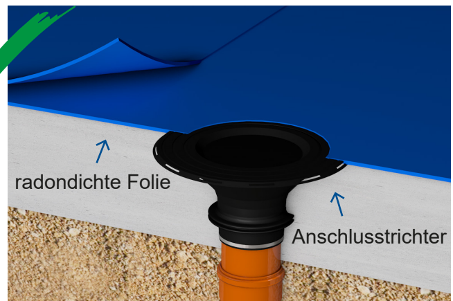
Unsere Empfehlung: Alternativ stehen Komplettsysteme als Anschlussstrichter-Lösung zur Verfügung, die neben der Abdichtung zur Bodenplatte einen Toleranzausgleich sowie die Anbindung einer radondichten Folie ermöglichen.
