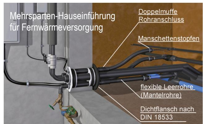
Bei Kellerwänden oder Bodenplatten aus wasserundurchlässigem Beton nach WU-Richtlinie empfiehlt sich der Einbau von Futterrohren.
