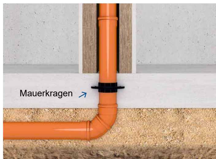
Sichere Abdichtung der Abwasserleitung mit einem Mauerkragen.
