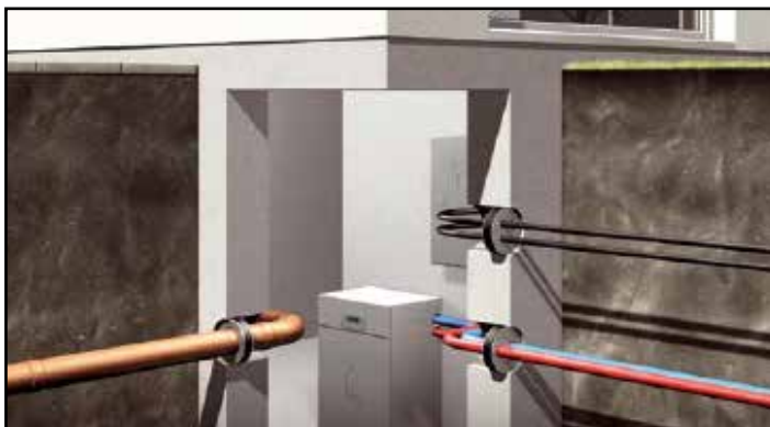
Kernbohrung mit FHRK-geprüfter Ringraumdichtung (GE 101).
