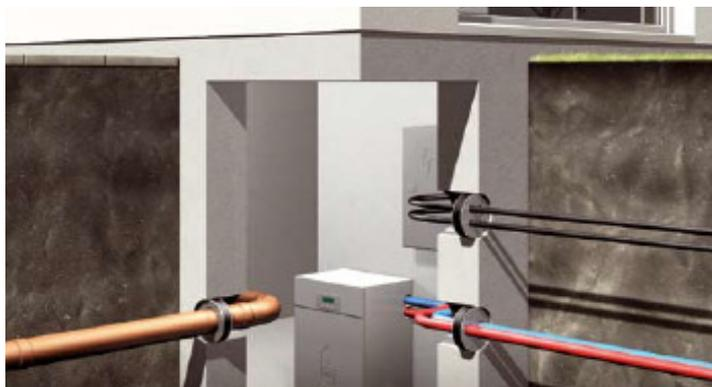
Kernbohrung mit FHRK-geprüfter Ringraumdichtung (GE 101)
