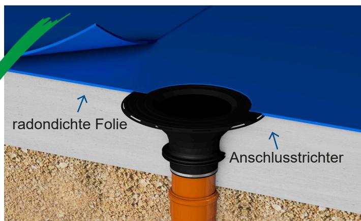
Unsere Empfehlung: Alternativ stehen Komplettsysteme als Anschlussstrichter-Lösung zur Verfügung, die neben der Abdichtung zur Bodenplatte einen Toleranzausgleich sowie die Anbindung einer radondichten Folie ermöglichen
