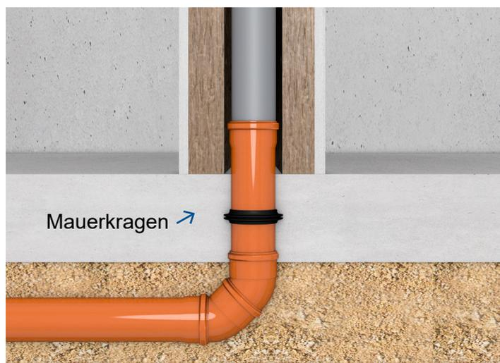
Sichere Abdichtung der Abwasserleitung mit einem Mauerkragen
