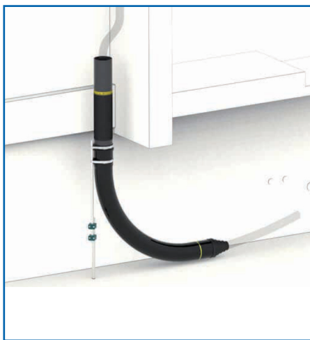
Bodeneinführung mit Vergussmörtel / Expansionsharz
