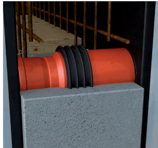
Wandeführung mit Dichtungsringen
