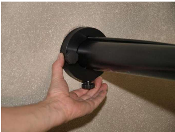
Bild 14: Verspann-Vorrichtung als Montagewerkzeug
